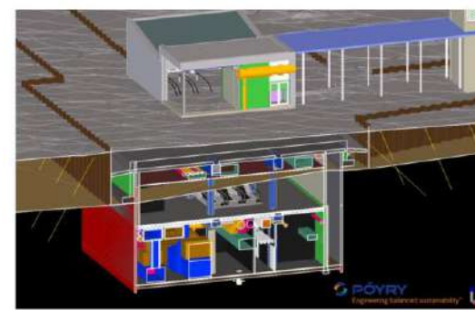
Kuva 14. Yhteensovitettu tietomalli työaineistosta. Mallin tuottajat Arkkitehdit Davidsson Tarkela Oy (ARK), Pöyry Finland Oy (RAK), Pöyry Finland Oy (KAT), Pöyry Finland Oy (GEO), Granlund Oy (LVI) ja Nissinen Niemistö (Creeclund, S).
